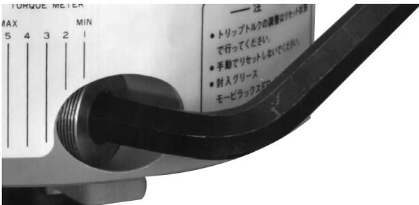
2. 在设定扭矩前，请在调节螺钉的露出螺纹部分涂 Loctite242 或与之相当的物品。扭矩设定后防止松动。
